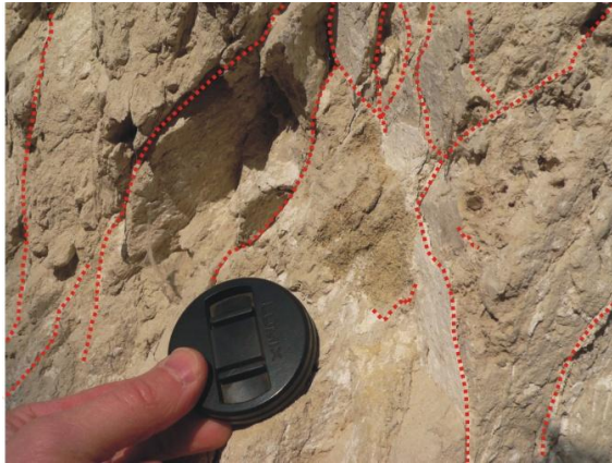
4E ábra A kőzetfal törésrendszere az A udvarban
