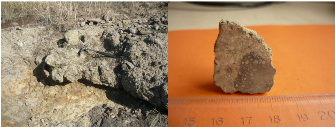
5.5.2A ábra A HT-01 mintát szolgáltató lávabreccsa, illetve a minta vágott felülete
